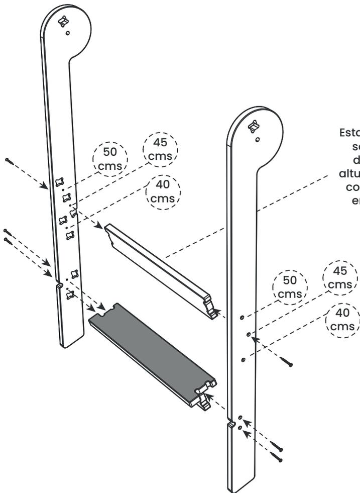
Esta pieza es uno de los soportes del piso, y dependiendo de la altura deseada se debe colocar en uno de los encajes mostrados aquí.
