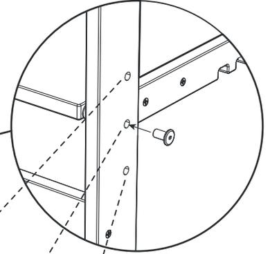
Esta pieza debe colocarse en el orificio adecuado para la altura deseada. La cual debe ser la misma utilizada en el punto 4.
